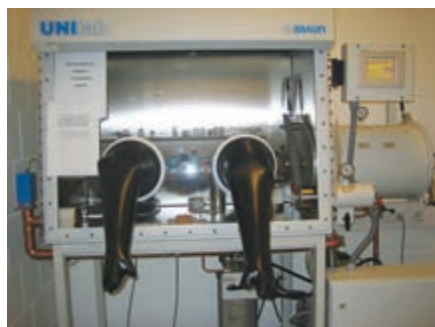
144 pav. Laboratorinės spintos (boksai) darbui argono atmosferoje
