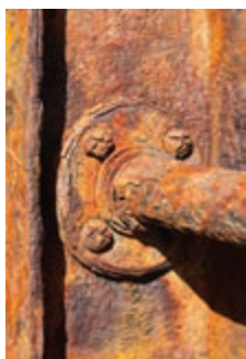
232 pav. Geležies ir plieno korozija
