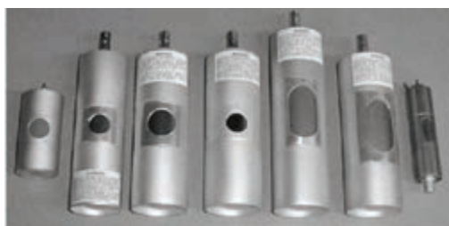
21 pav. Rentgeno spindulių generavimo vakuume sistemos, radioaktyvumo detektoriai su berilio langais ir berilio langas, pro kurį į tiriamąją medžiagą patenka rentgeno spinduliuotė
