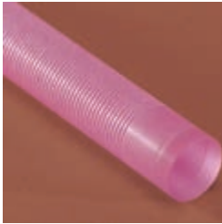
332 pav. Nd: YAG lazerio strypas ir kristalai
