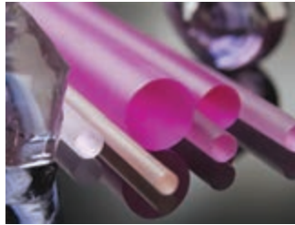
332 pav. Nd: YAG lazerio strypas ir kristalai
