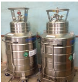
8 pav. Suskystintas helis ir suskystinto helio talpos
