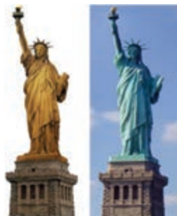
262 pav. Edinburgo observatorijos bokštas. Originalus varis nuo 1894 m. yra oksidavęsis (žalia patinos spalva), o rekonstruotas 2010 m. dar nepalietas oksidacijos (rausvai ruda spalva). Laisvės statula ir Mineapolio rotušė, JAV
