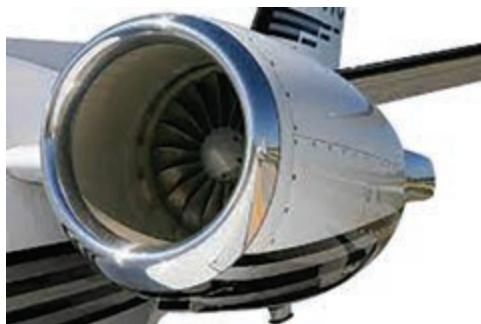
184 pav. Iš titano lydinių gaminamos lėktuvų detalės
