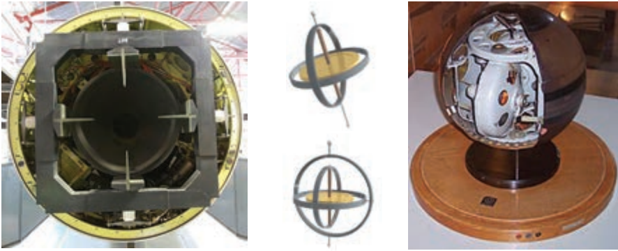
22 pav. Raketų reaktyvinės tūtos, padarytos iš berilio, giroskopai ir girokompasas
