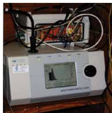
3 pav. Aukštaitijos KMS aerosolių tyrimo stotis ir Fizikos instituto mokslininkų prietaisas BAOAD matuoti
