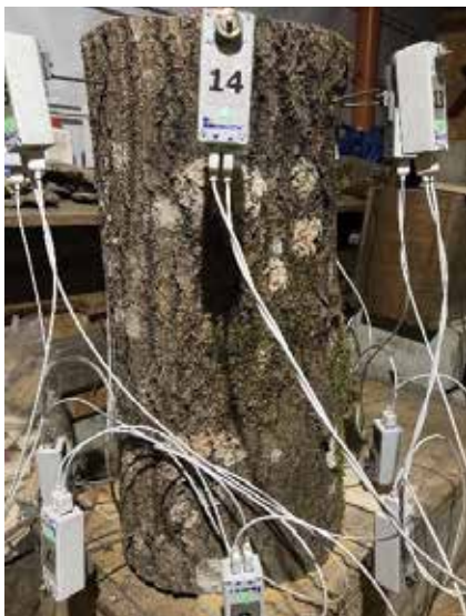
4 pav. Akustinio tomografo davikliai uždėti ant drebulės sortimento
